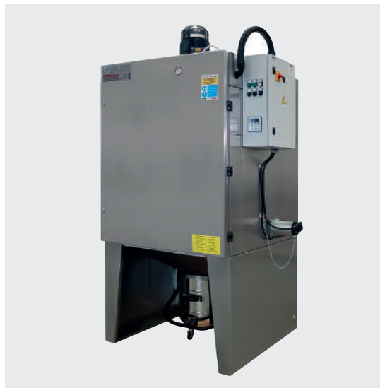
IPERJET inox de acero inoxidable con cartuchos para uso alimenticio
